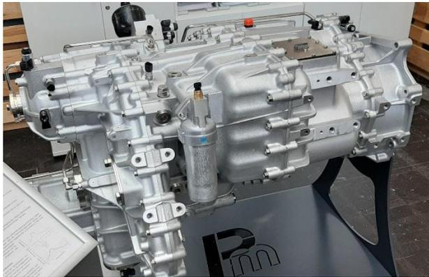
Verband VTP1750 Getriebe mit Cat Motor C9.3B für SynTrac Trägerfahrzeug
