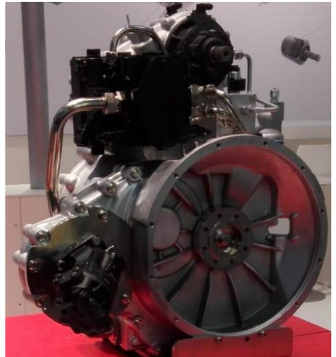
Variabler Power Divider – VPD2500 für Reinigungsfahrzeug
